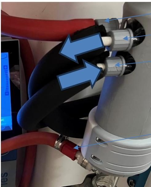
1. Anschluss an die Vakuumpumpe
