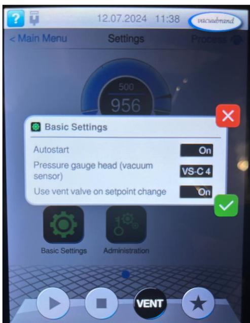
Abbildung 39: Grundeinstellung für den externen Vakuum-Sensor
