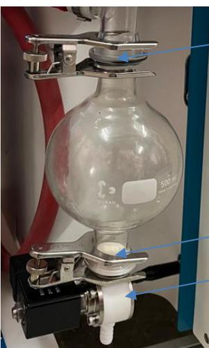
Abbildung 43: Angeschlossener Rundkolben mit Ventil
