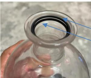
Abbildung 42: O-Ring Satz im Kugelschliff
