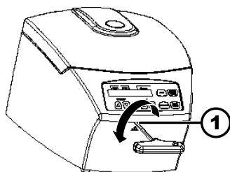
Slika 16: Otključavanje poklopca u slučaju nužde
