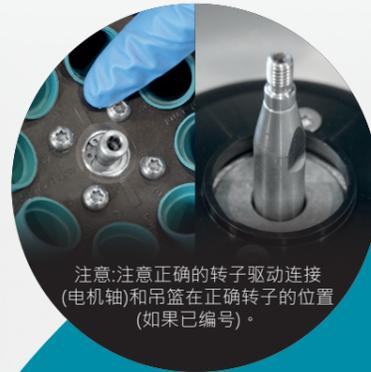
注意：注意正确的转子驱动连接（电机轴）和吊篮在正确转子的位置（如果已编号）。
