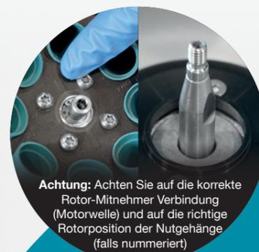
**Achtung:** Achten Sie auf die korrekte Rotor-Mitnehmer Verbindung (Motorwelle) und auf die richtige Rotorposition der Nutgehänge (falls nummeriert)
