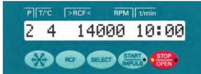
Los modelos MIKRO 200 / 200 R, MIKRO 220 / 220 R, UNIVERSAL 320 / 320 R y ROTOFIX 46 / 46 H se pueden operar con esta variante del panel de mando N con celeridad y comodidad. La selección de los parámetros se realiza con la tecla de selección. Con un mando giratorio se ajustan los valores, guardándose se pulsando el botón Start/Impuls.
