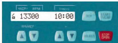
El manejo de los modelos EBA 200, EBA 200 S, HAEMATOKRIT 200 y MIKRO 185 se realiza con el control de mando E Plus. A diferencia del control de mando E, en éste pueden ajustarse la velocidad de rotación (RPM) o la aceleración centrífuga relativa (RCF).
